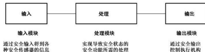
图 7 软件的一般架构模型
